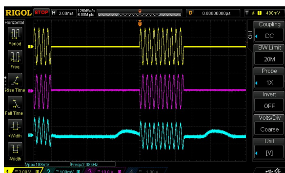
Audiophonics Connex: Voedingsrimpel 188 mVpp
