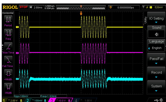
MeanWell: Voedingsrimpel 188 mVpp
