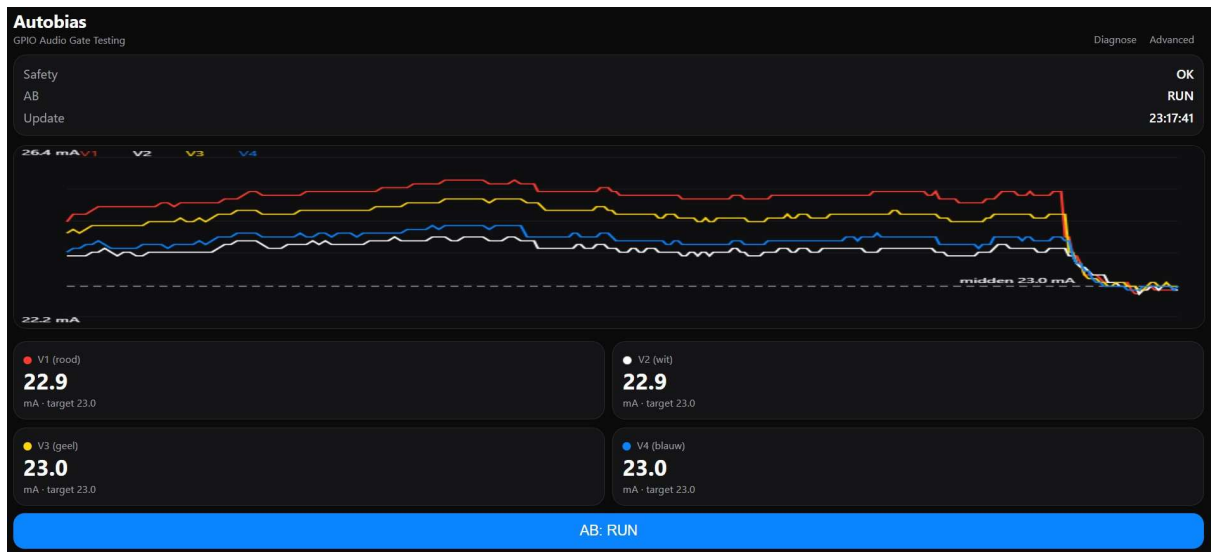
Figuur 32 - AB RUN: drift wordt door de ETbias teruggebracht naar het ingestelde target.
