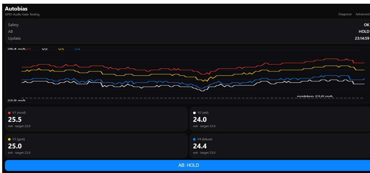
Figuur 31 - AB HOLD: de vier buisstromen driften mee zonder actieve correctie.
