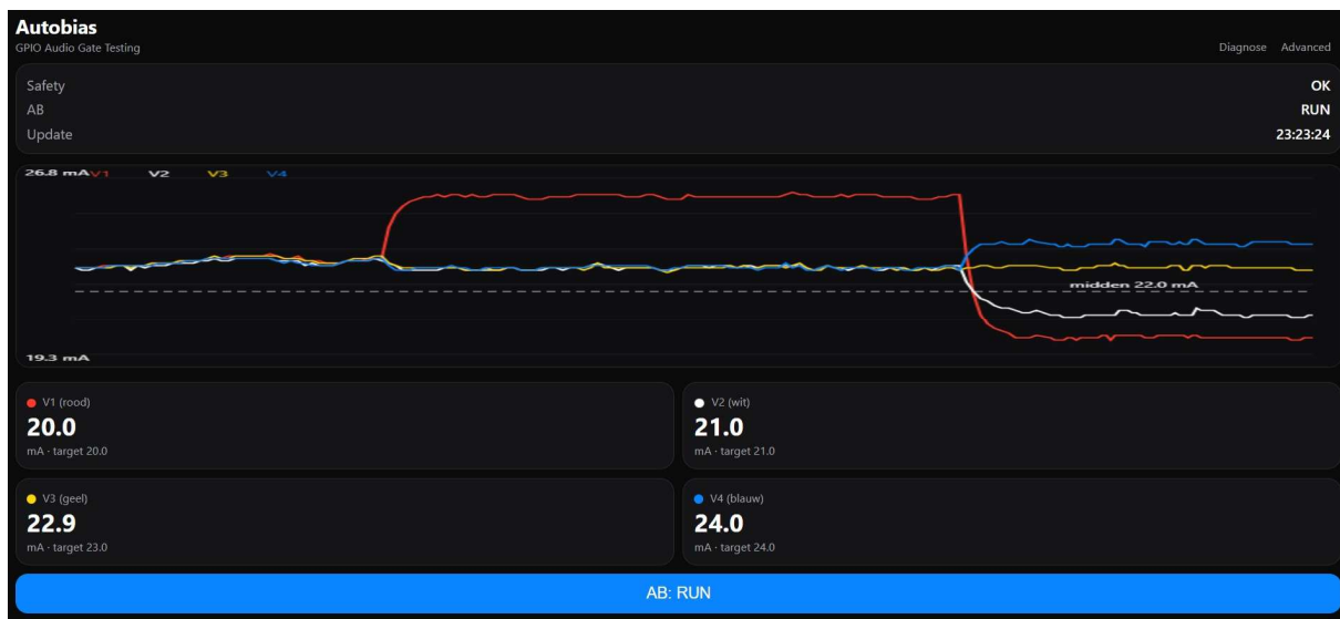
Figuur 34 - Per-buis targets: V1, V2, V3 en V4 kunnen bewust verschillend worden ingesteld.
